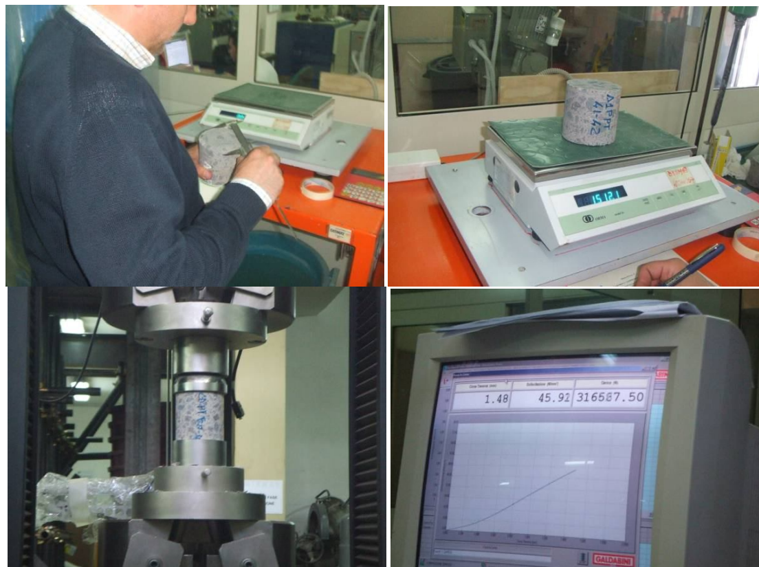
Figura 25 – Fasi di prova di compressione sui campioni di calcestruzzo
