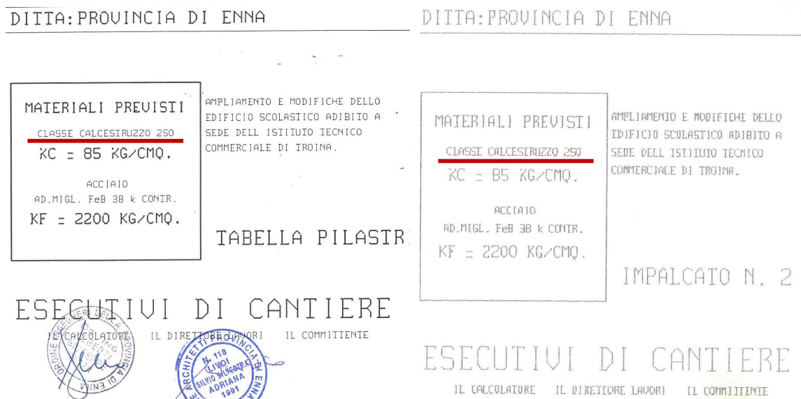
Figura 39 – Calcestruzzo da progetto – ampliamento
